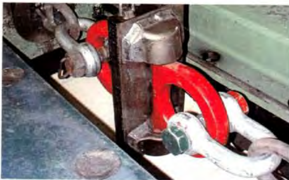
RUD 에서의 생산공정검사. 테스트 기계로 조인 상태에서 2000 kN 의 최소 파괴하중을 가진 용접식의 리프팅포인트 타입 RBS-50t의 인장검사.
